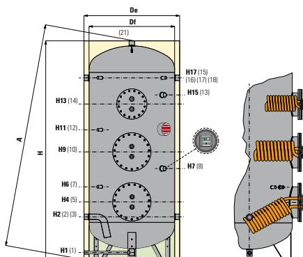
Le capacità dal 1500 al 5000 litri sono dotate, al posto dei piedi, di una pratica "gonna" di appoggio che rende possibile la movimentazione degli apparecchi con transpallet e muletti.
